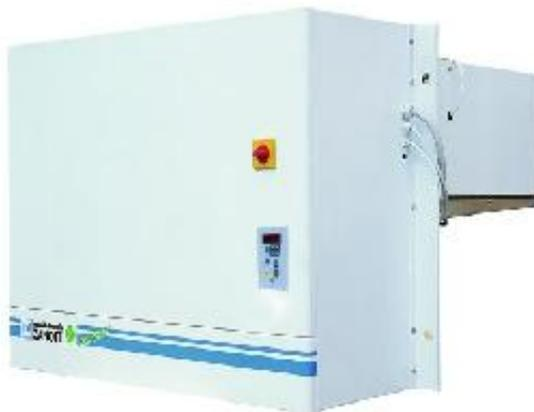
**Données Techniques****Puissance absorbée nominale** 5.2 kW**Tension** 400 V /3N~/ 50 Hz**Intensité absorbée nominale** 12.2 AMP**Poids** 250 KG**Débit d'air condenseur** 4000 m<sup>3</sup>/h**Débit d'air évaporateur** 5800 m<sup>3</sup>/h**Projection d'air** 9.5 m
